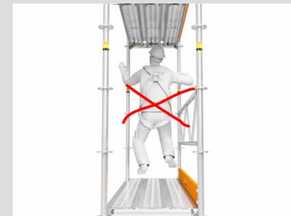
足場板の上で飛び跳ねないでください。
