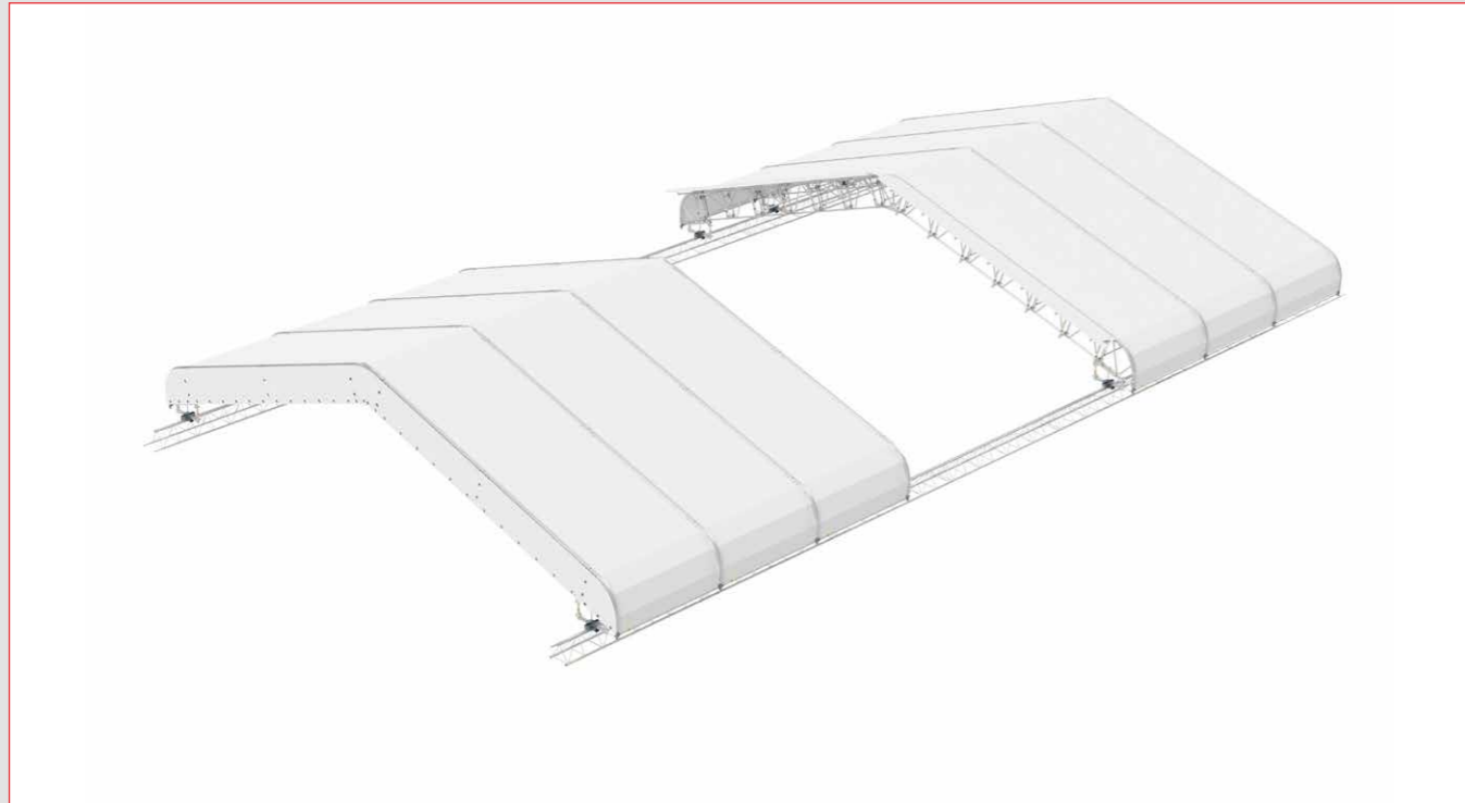
二重勾配屋根2つを使用した可動Keder屋根。大型建物で広い面積を開ける必要がある場合に最適なソリューションです。
